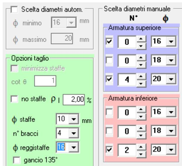
Fig. P.6 - Scelta manuale dei diametri.
