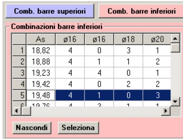
Fig. P.5 - Scelta di una combinazione diversa di barre inferiori.
